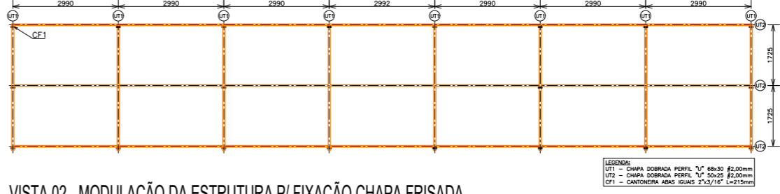
VISTA 02 - MODULAÇÃO DA ESTRUTURA P/ FIXAÇÃO CHAPA FRISADA
